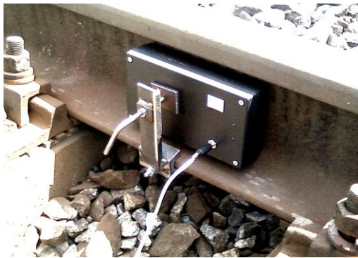
Рис. 5. Датчик дослідного зразку ІПП-01 на рейці
